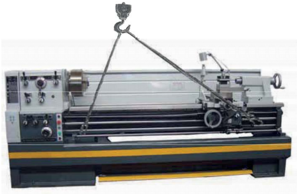
Мал. 4 Рекомендована схема стропування верстата
