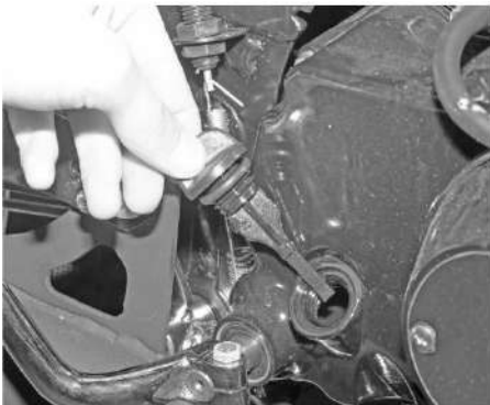
Рис. 6.1. Перевірка рівня мастила у двигуні
