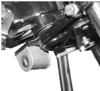
Рисунок 4.3. Замок блокування керма
