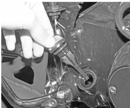
Рис. 6.1. Перевірка рівня мастила у двигуні Для перевірки рівня мастила необхідно пробку-щуп (див. рис. 6.2.). Вставити в заливну горловину, при цьому не закручуючи
