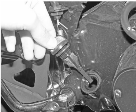
Рис. 6.1. Перевірка рівня мастила у двигуні
