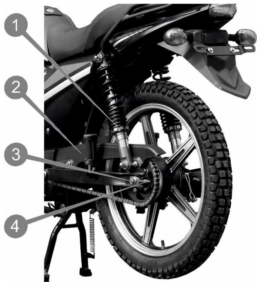
Рис. 17. Ланцюгова передача і маятникова підвіска
