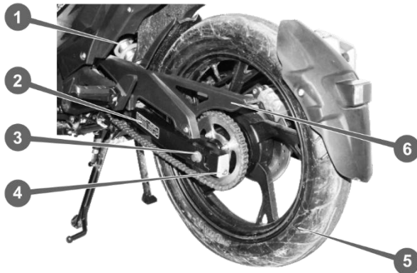
Рис. 6.7. Ланцюгова передача і маятникова підвіска
