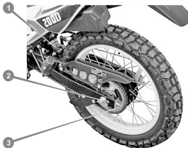
Рисунок 12. Ланцюгова передача і маятникова підвіска
