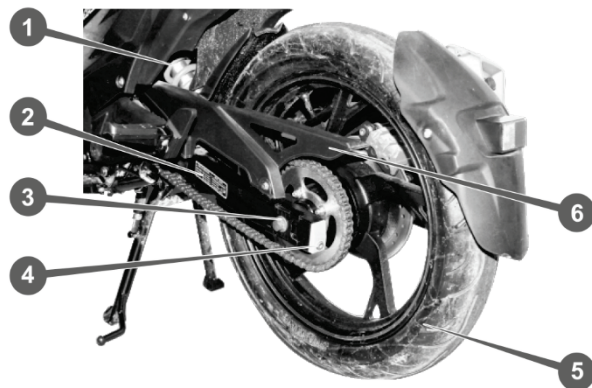
Рисунок 6.6. Ланцюгова передача і маятникова підвіска
