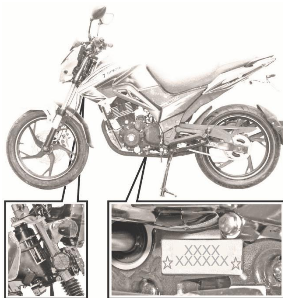
Рисунок 3.7. Розташування номера двигуна мотоцикла
