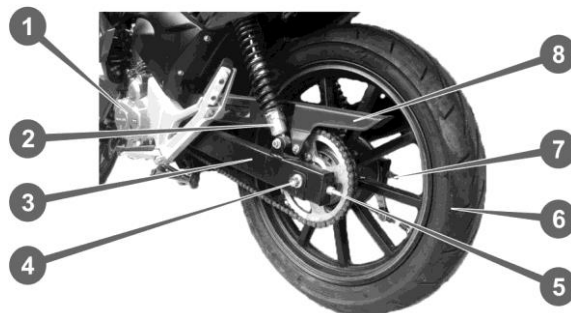
Рисунок 18 – Ланцюгова передача і маятникова підвіска
