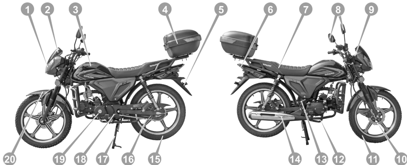
Рисунок 1. Основні вузли та агрегати
