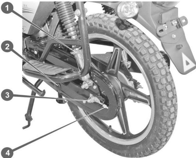
Рисунок 16. Ланцюгова передача і маятникова підвіска
