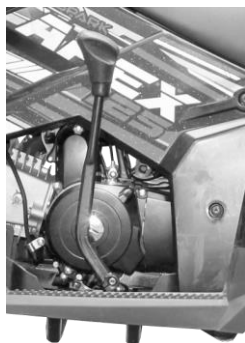
Рисунок 3.6.1 Важіль вибору напрямку руху для SPARK APEX 125
