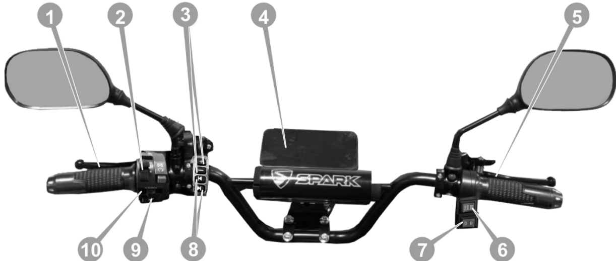
Рисунок 1.2. Блоки перемикачів на рукоятках керма.
