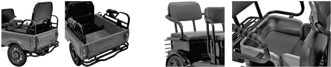
Рисунок 5.1. Трансформація пасажирського місця у вантажний відсік.
