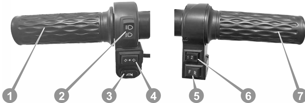
Рисунок 3.4. Блоки перемикачів на рукоятках керма.
