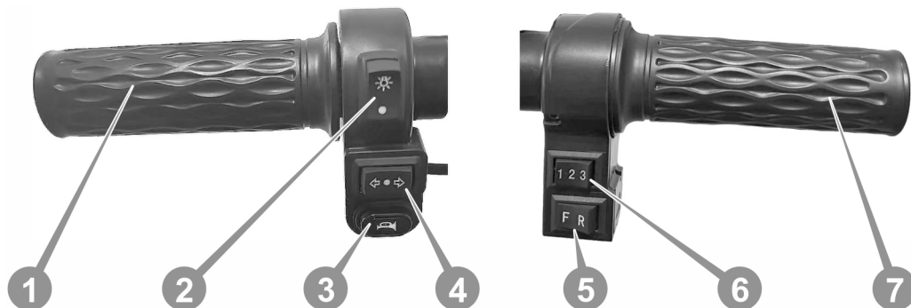
Рисунок 3.4. Блоки перемикачів на рукоятках керма.
