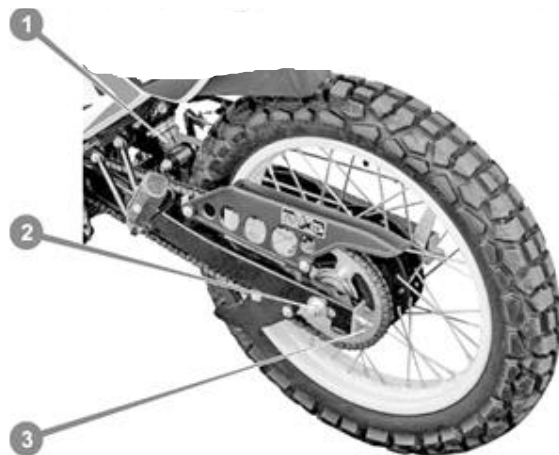
Рисунок 16. Ланцюгова передача і маятникова підвіска
