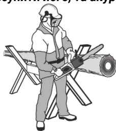
Рисунок 11. Схема розпили колоди з використанням козових опор.
