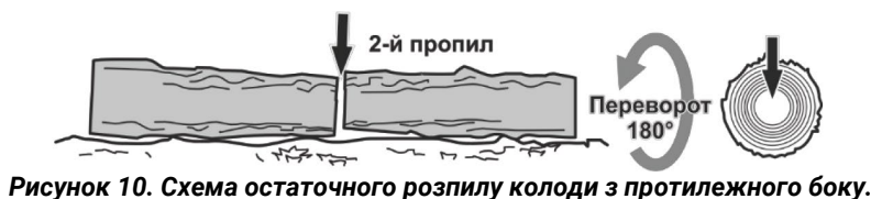
Рисунок 10. Схема остаточного розпили колоди з протилежного боку.
