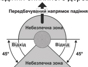
Рисунок 8. Схема зони падіння дерева.
