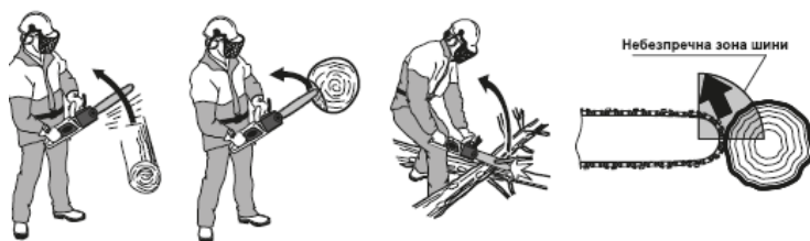
Рисунок 2. Приклади появи небезпеки «віддачі» виробу.
