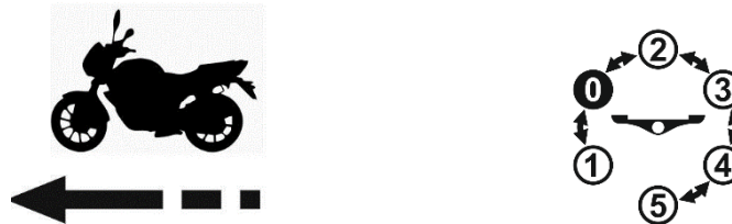
Рис. 4.2. Схема перемикання передач
