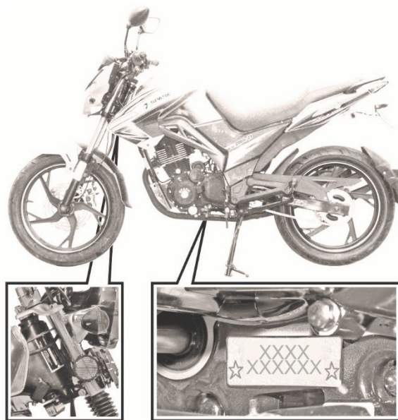
Рисунок 3.7. Розташування номера двигуна мотоцикла
