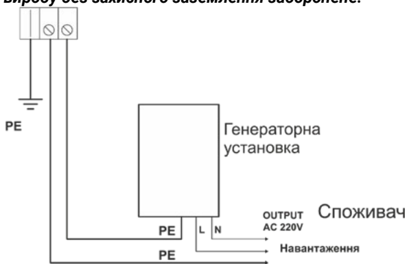
Рисунок 13. Схема заземлення виробу.
