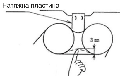
Рисунок 5.3. Регулювання натяжної пластини.
