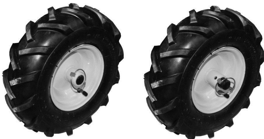
Рисунок 4.15. Ліве колесо з різними варіантами колії
