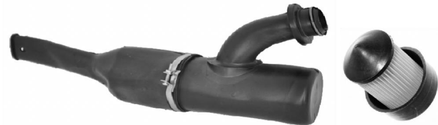
Рисунок 15. Повітряний фільтр і фільтрувальний елемент
