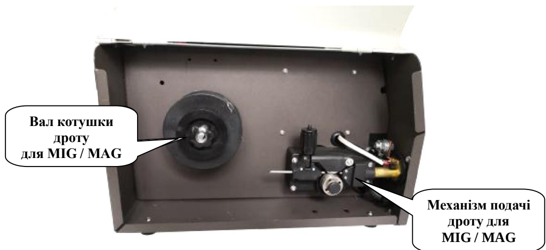
Мал. 8: Внутрішня структура подачі дроту джерела зварювального струму
