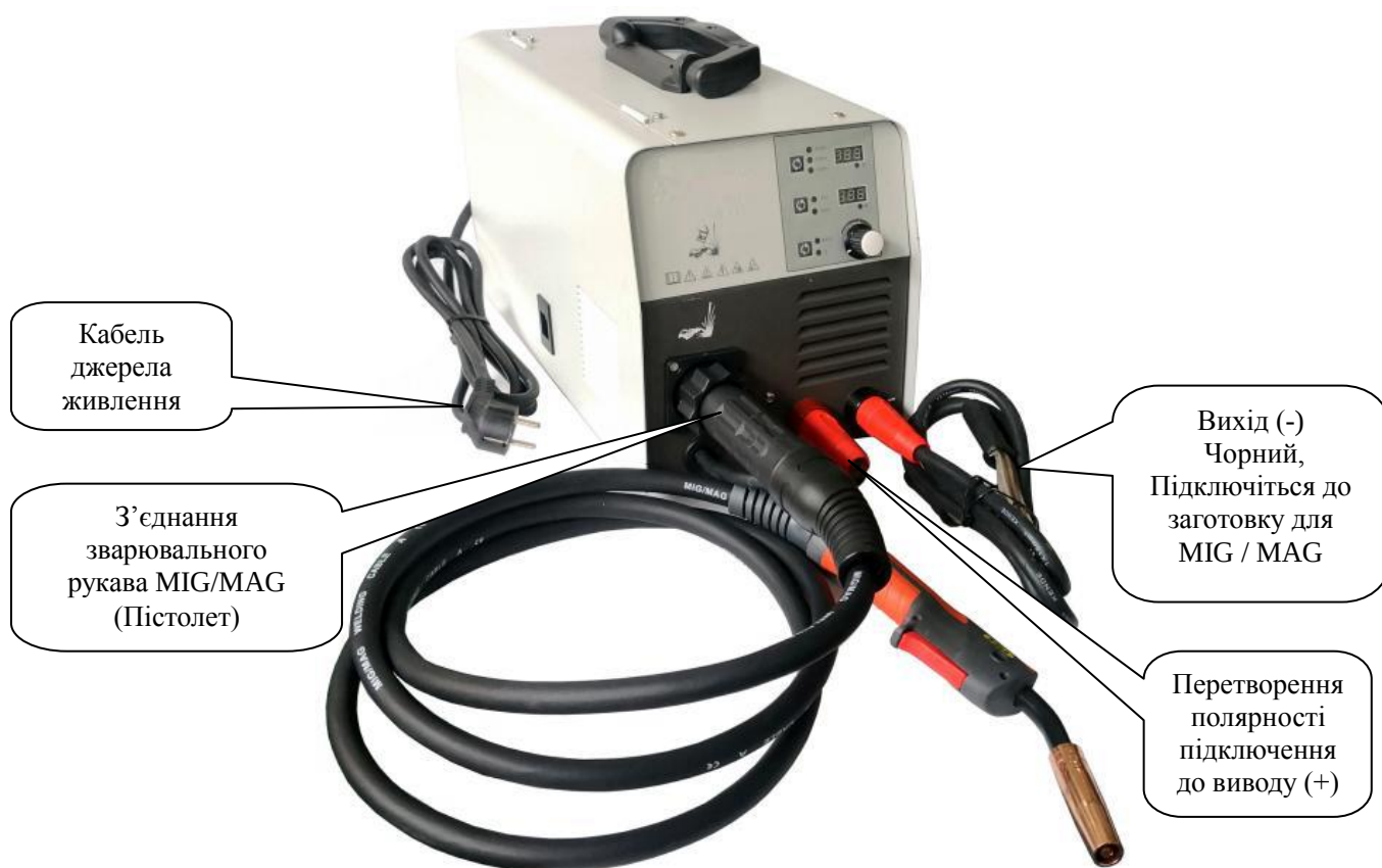
Мал. 9: Підключення методу зварювання MIG / MAG
