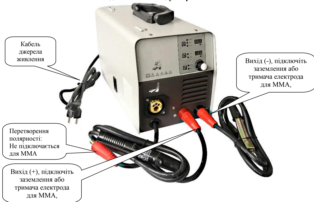
Мал. 10: З'єднання методом MMA зварювання
