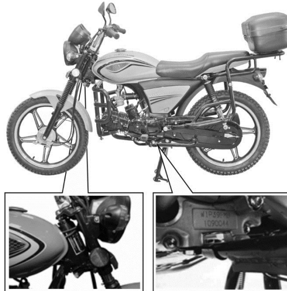
Рис. 3.7. Номери шасі та двигуна.
