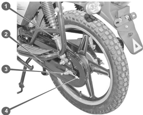
Рис. 5.7. Ланцюгова передача і маятникова підвіска.
