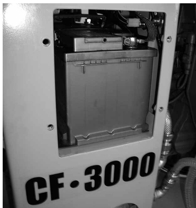
CF-3002 D справа, крышка аккумулятора снята
