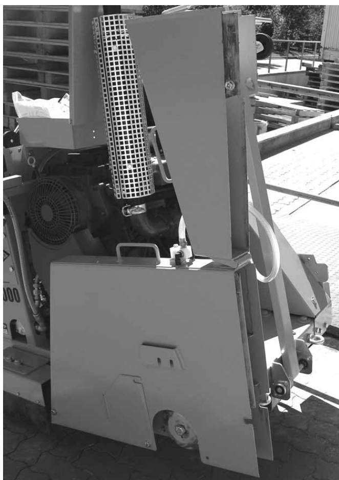
Защитный колпак откинут, (кожух диска смонтирован справа)
