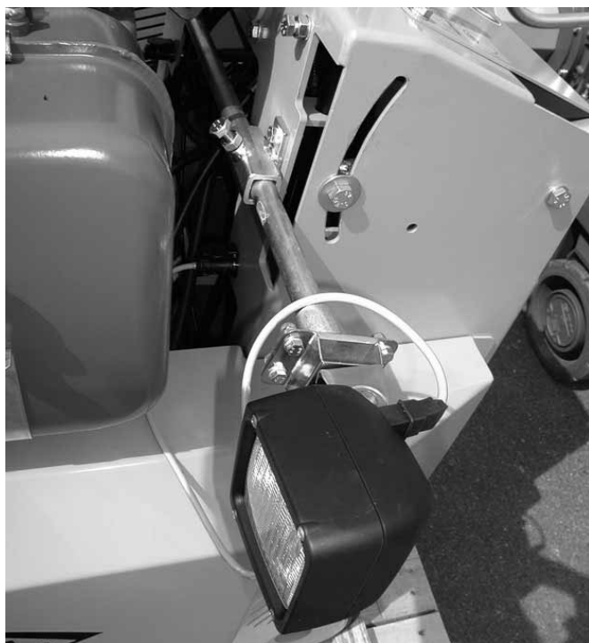
CF-3002 D, с доп. фарой (смонтирована слеват)
