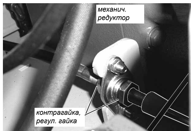
Трос Боудена рычага подачи, регулир. устройство перед механ. редуктором
