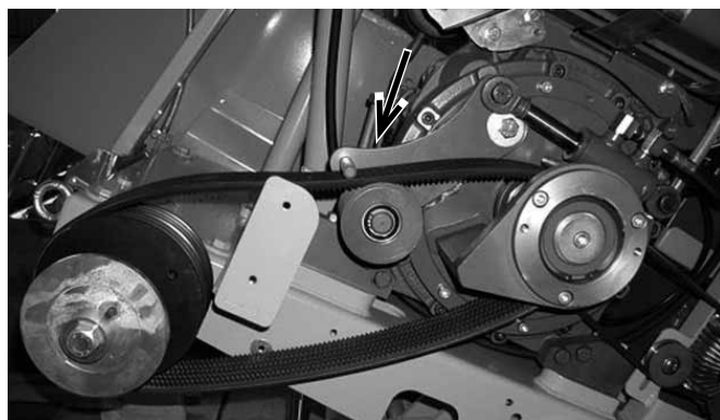
Сцепление режущего вала выключено (клиновые ремни вала ослаблены, кожух снят)
