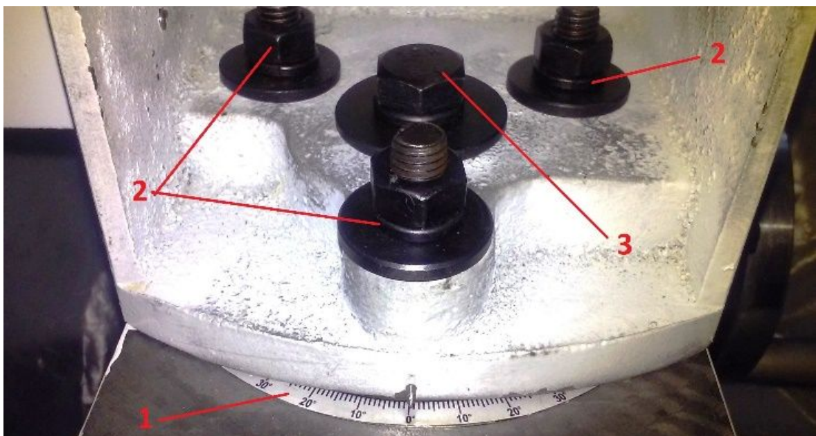
Мал. 1.5 Принципова будова верстата 1 – масштабна лінійка повороту (нахилу) шпиндельної голови; 2 – болти фіксування
