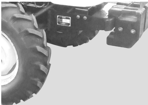
Малюнок 1.1. Розміщення номера шасі
