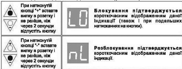
Рисунок 12. Послідовність дій для блокування кнопок терморегулятора обігрівача
