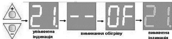
Рисунок 13. Послідовність зміни індикації після вимкненні терморегулятора
