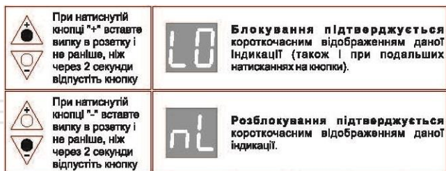
Рисунок 10. Послідовність дій для блокування кнопок терморегулятора обігрівача
