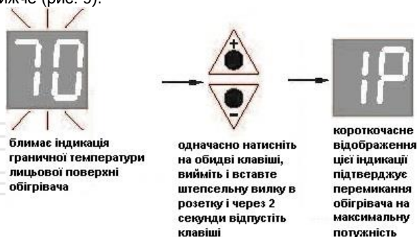
Рисунок 9. Послідовність дій при встановленні максимальної потужності
