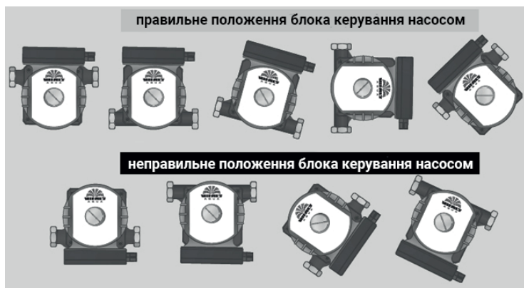
Рисунок 3. Схема положень встановлення насоса у систему
