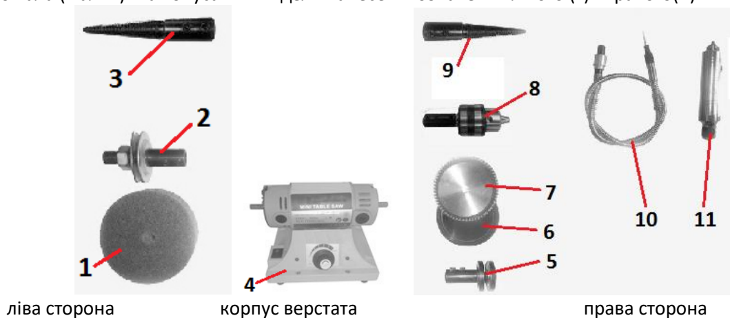
Мал. 2 Схема установки конусів і оправок
