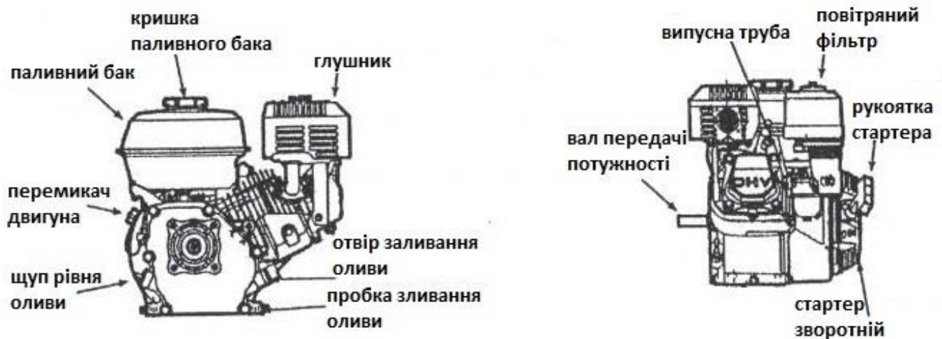
Мал. 2 Основні вузли двигуна віброплити
