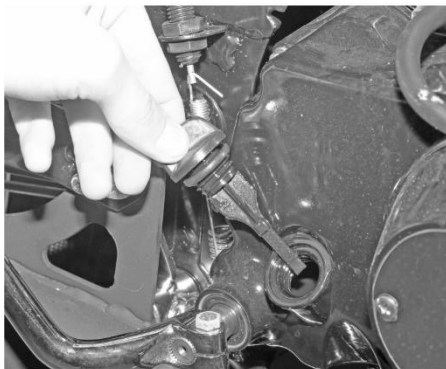
Рис. 6.1. Перевірка рівня мастила у двигуні
