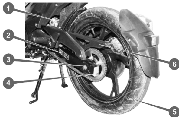
Рисунок 6.6. Ланцюгова передача і маятникова підвіска
