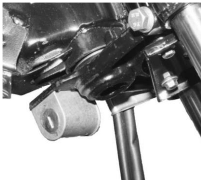
Рисунок 4.3. Замок блокування керма
