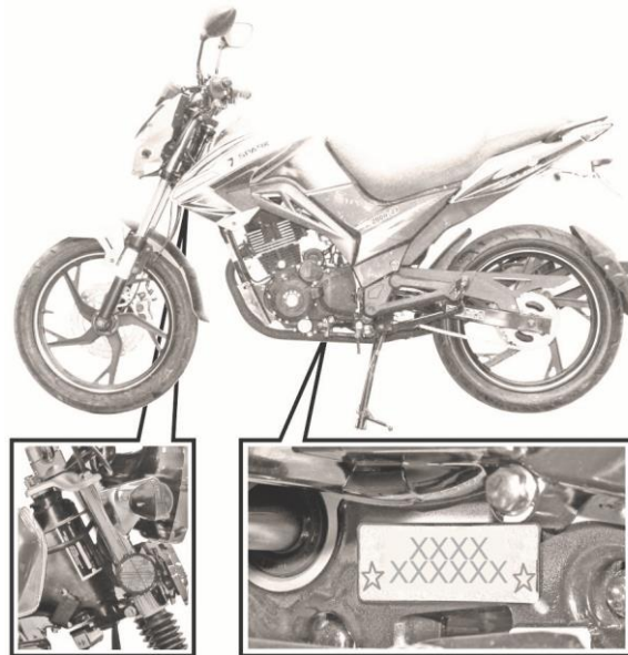
Рисунок 3.7. Розташування номера двигуна мотоцикла
