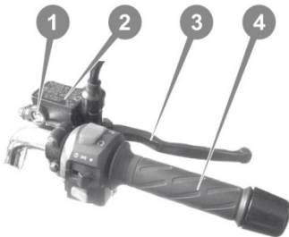
Рисунок – 20. Привід переднього гальма
