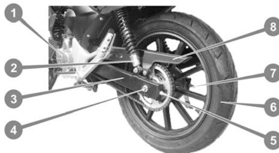
Рисунок 18 – Ланцюгова передача і маятникова підвіска
