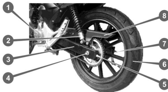
Рисунок 18 – Ланцюгова передача і маятникова підвіска
