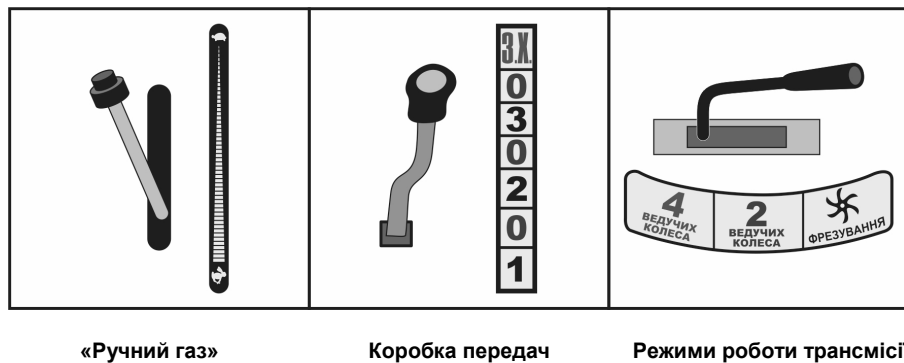
Рисунок 4.2. Важелі управління напрямом та швидкістю руху
