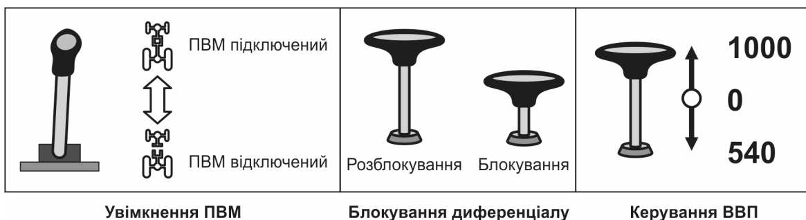
Рисунок 4.2. Важелі увімкнення ПВМ, блокування диференціала та керування ВВП.
