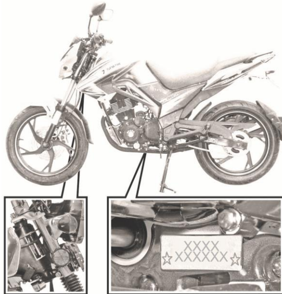
Рисунок 3.7. Розташування номера двигуна мотоцикла
