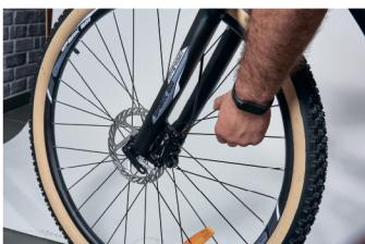
Якщо гальмівний диск неприємно третиться об колодки, встановіть одинаковий зазор між диском та колодками: однією рукою утримуйте каліпер, другою – поперемінно затягуйте болти кріплення до тих пір поки гальмівний диск не буде чіпати колодки.
