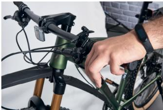
Послабте два болта кріплення каліпера. Натисніть на гальмівну ручку кілька разів та утримуйте її в натиснутому стані: спробуйте прокрутити колесо вперед - назад.
