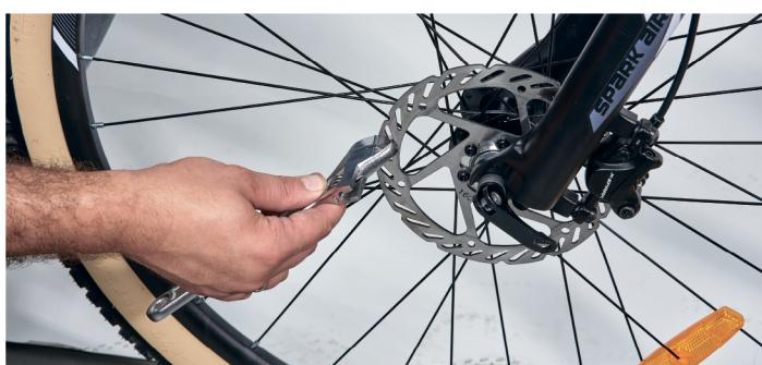
Коли помітили переривчасте човгання, то це ознака того, що ротор трохи прогнутий. У такому випадку встановіть зону тertia, і з якого краю колодки чіпляють ротор. Розверніть це місце на 180 ° відносно каліпера і обережно натисніть на протилежний край. Краще виконувати цю операцію у кілька заходів до повного зникнення тertia.
