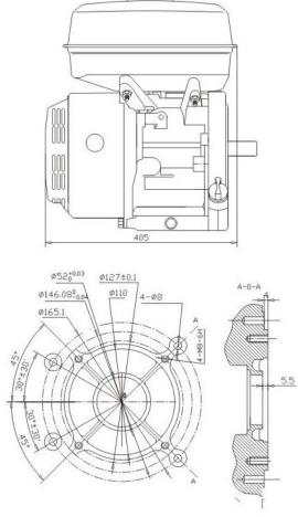
Двигатели выпускаются со встроенным шестеренчатым редуктором, уменьшающим обороты двигателя в 2 раза:
