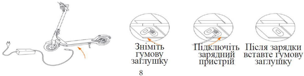
Рисунок 6. Схема зарядки батареї електросамокату.
