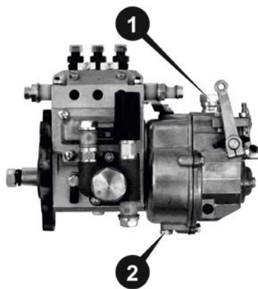
Рисунок 10.1. – Заливний (1) та зливний (2) отвори мастила ПНВТ
