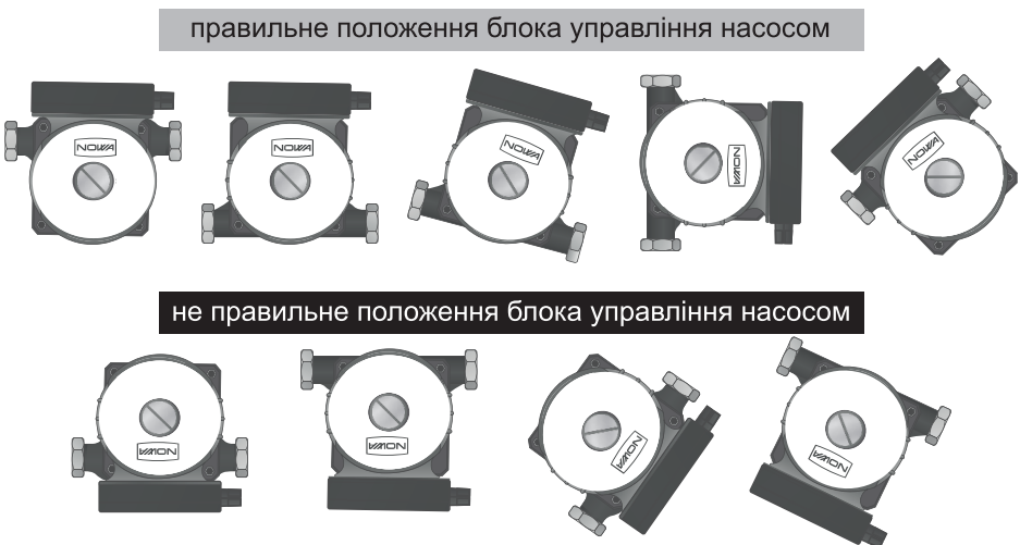
Рисунок 3. Схема положень встановлення насоса у систему.
