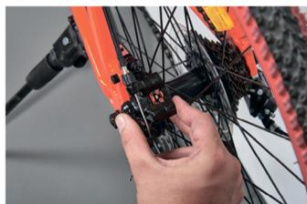
Послабте два болта кріплення каліпера. Виставте положення каліпера, щоб відстань між ним та колодками була однаковою.
