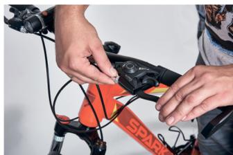
Встановіть зручну відстань від грипси до керма, при якому гальмо буде затиснуте. Для цього скористайтесь регулювальною гайкою на гальмівній ручці: при її викручуванні ручку віддаляється від грипси в момент схоплення гальма, а при закручуванні - наближається.
