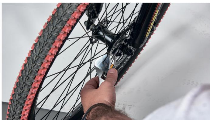
Перевірте, чи непогнутий гальмівний диск. Якщо це так, обережно вирівняйте його спеціальним ключем для ротору або, при відсутності, звичайним розвідним ключем.
