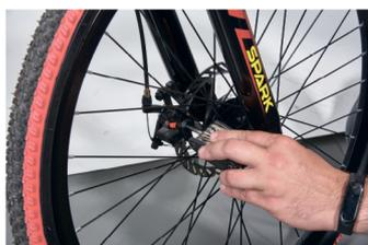
Перевірте хід ручки. Якщо він великий, підведіть колодки ближче до диска. Починайте з колодки, розташованої ближче до втулки. На зовнішній стороні каліпера, де встановлена права колодка є гвинт під шестигранник: при закручуванні гвинта, колодка наближується до тормозного диска, а при викручуванні – віддаляється.
