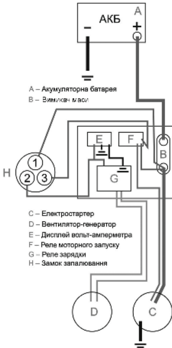
Рисунок 42. – Електросхема мотоблоків з електростартером
