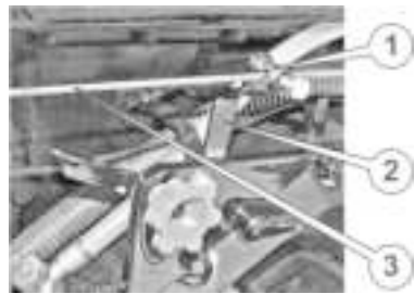
Рисунок 29. – Тяга подачі палива
