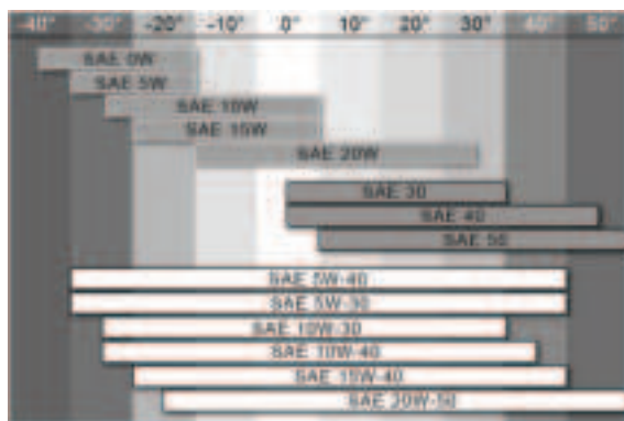
Рисунок 33. – Температурно-діапазонний графік в'язкості моторного мастила
