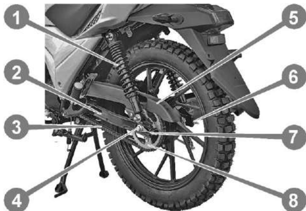
Рис. 6.7. Ланцюгова передача і маятникова підвіска
