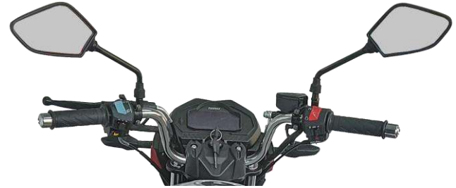
Рисунок 3.2. Загальний вид керма
